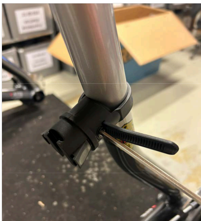
⑥ Ajuste el tornillo/la correa con la llave Allen de 4 mm hasta que la correa esté ajustada.
